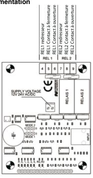
Modèle 12 V/24 V-AC/DC: La tension d'alimentation se branche aux bornes "SUPPLY VOLTAGE". La valeur de la tension d'alimentation nominale est indiquée sur la platine ainsi que sur le relais et elle doit être respectée conformément aux indications dans la fiche technique pour assurer un fonctionnement impeccable. Une tension d'alimentation trop élevée peut entraîner des endommagements de l'appareil. Une tension d'alimentation trop faible ou instable peut causer un dysfonctionnement.
