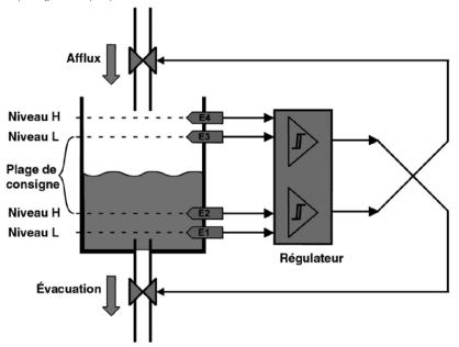
Le récipient de liquide contient quatre électrodes (E1..E4) qui se dressent dans le medium à la position de fonctionnement souhaitée. Une cinquième électrode au fond du récipient (pas représenté sur l'image) sert d'électrode de référence.
