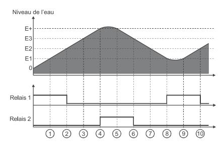
État initial : Le récipient est d'abord vide. L'électrode E1 n'est pas en contact avec l'eau. Le relais 1 est serré (la soupape de remplissage est ouvert p. ex.). Le niveau de l'eau dans le récipient monte. L'eau et l'électrode inférieure E1 (1) sont en contact ce qui ne change pas l'état de relais. Seulement après le contact de l'électrode E2 avec l'eau (2), le relais 1 s'arrête (la soupape de remplissage se ferme p. ex.).
