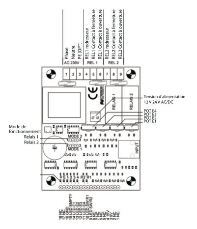
Normalement, tous les potentiomètres doivent être réglés à la même position. Seulement si les écarts entre les électrodes et l'électrode de référence sont très différents ou si les câbles de branchement sont très longs, il est raisonnable de régler différentes sensibilités. Après avoir modifié la longueur du câble de branchement, vérifiez le réglage.
