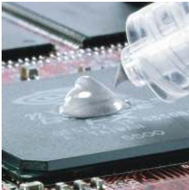
Les pâtes KP 96, KP 97 et KP 98 sont des céramiques remplis de silicone mono-composant avec une haute conductivité thermique. Les pâtes thermiques non agglomérées ne se dessèchent pas. Les éléments en silicone ne sortent pas des pâtes.
