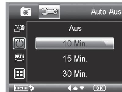
Lorsque le mode économie d'énergie arrêt auto est activé, l'appareil s'éteint automatiquement après un temps défini. La durée de fonctionnement est ainsi rallongée. Sélectionnez «Aus» (arrêt) pour désactiver le mode économie d'énergie.
