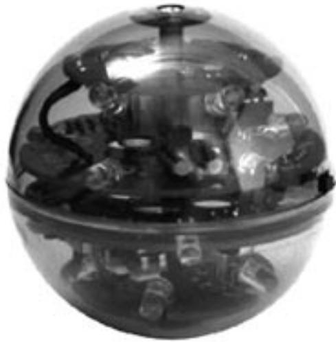
Ce ballon est conçu à partir de plastique transparent et coloré et contient 20 diodes d'émission infrarouges à l'intérieur. Ces diodes infrarouges peuvent aussi bien émettre de la lumière infrarouge en continu (pour les championnats de la Robocup Junior) qu'en mode pulsé. Les robots peuvent ainsi facilement détecter le ballon.
