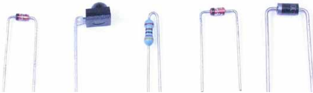
Fig. 3.3.: Composants avec des fils pliés correctement
