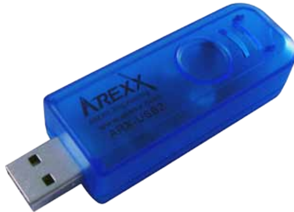
Fig. 4.1a.: Implantation du transmetteur infrarouge USB
