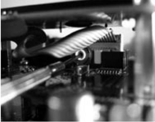
Afin d'atteindre plus facilement le potentiomètre, vous pouvez dévisser l'écran (ou ne pas le fixer du tout tant qu'il n'est pas correctement réglé). La fiche doit cependant restée branchée ! Cela vous permet d'ajuster le potentiomètre alors que le robot est allumé.
