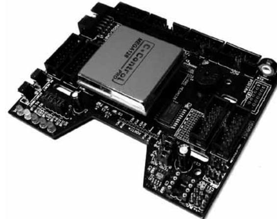
Vous devez tout d'abord enficher correctement le CCPRO MEGA128 Unit sur le module d'extension. Pour votre sécurité, veillez à ne manipuler le module qu'avec un objet mis à la terre, afin qu'il se décharge. Par exemple, un tuyau nu d'un corps chaud ou d'une pièce métallique d'un boîtier d'ordinateur (prise à 3 pôles !).
