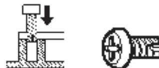
Les vis avec un filetage auto-tarauteur fonctionnent comme des vis à bois, c'est-à-dire que la vis perce un trou en tournant et se fixe ainsi dans le matériau. C'est pourquoi les vis de ce type ont un filetage plus grand et une pointe plus affûtée que les vis ordinaires.
