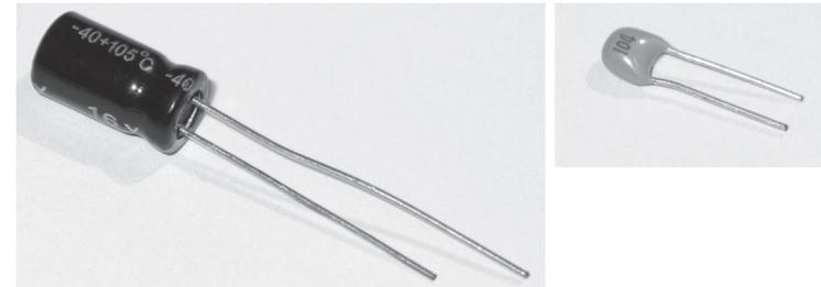
Insérez les condensateurs dans les trous caractéristiques correspondant, courbez les fils métalliques séparément les uns des autres et soudez les proprement à la piste conductrice.
