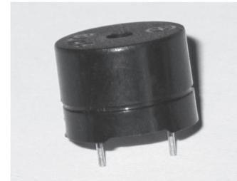
LS1 = transducteur acoustique (boîtier de forme cylindrique)
