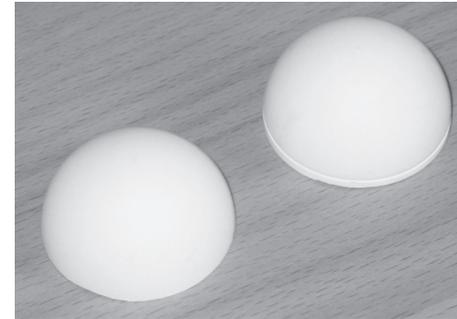
En fonction de la surface sur laquelle le PRO-BOT128 se dirigera plus tard, vous pouvez diminuer légèrement la taille des moitiés de balle afin que de minimiser les basculements du robot.
