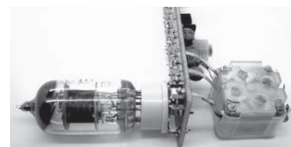
Raccordement de la platine au condensateur variable
