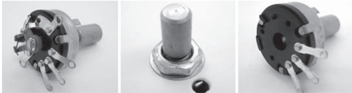
Bouton de volume avec interrupteur et bouton de rétroaction (potentiomètres)
