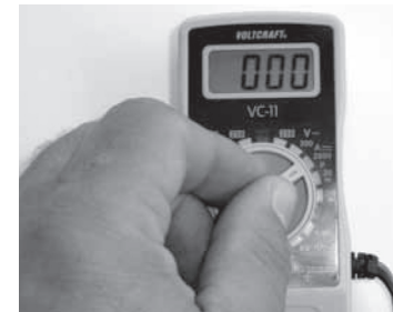
Image 20 : veillez à sélectionner la bonne grandeur (par ex. «courant continu», lorsque vous souhaitez mesurer des courants continus).
