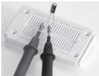
Image 34 : les condensateurs doivent uniquement être mesurés en dehors des circuits ou des parties de circuit. Le condensateur à mesurer doit être enfiché sur la platine d'expérimentation. Les deux cordons sont branchés en respectant la polarité.
