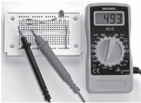
Image 57 : Sur les deux résistances de 1 kΩ branchées en parallèle, seule la résistance totale de 493 Ω peut être mesurée.
