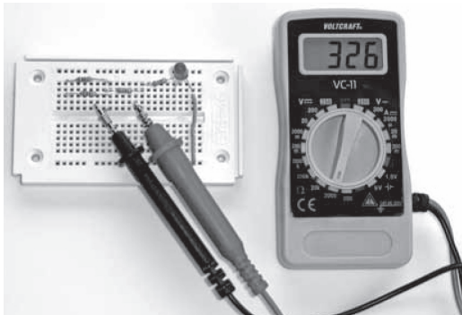
Image 59 : la mesure de chaque résistance d'un circuit s'effectue correctement seulement s'il n'y a pas d'autres composants branchés en parallèle.
