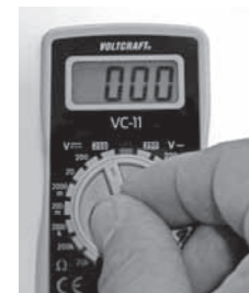
Image 21 : l'appareil doit être commuté sur la plage de mesure maximum avant toute mesure. Avec cet appareil, elle est située sur la plage de tension continue 250 V.
