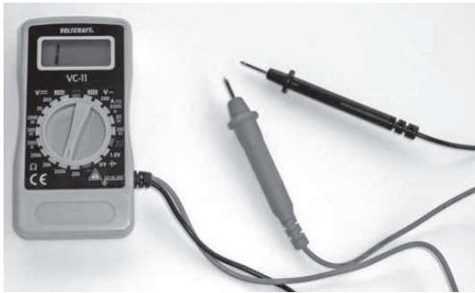
Image 51 : lorsque les cordons sont éloignés, la résistance est infiniment grande, ce qui est indiqué par « 1 ». Cela indique donc une rupture de câble ou bien des brins introuvables pour un câble multibrins.
