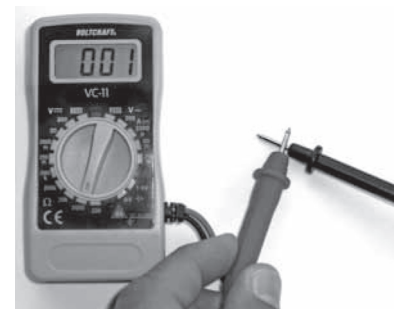
Image 50 : lorsque les deux cordons sont maintenus ensemble, le multimètre indique 0,0 \Omega ou 0,01 \Omega lors de la mesure d'une résistance. Le passage de câble est ainsi indiqué, celui-ci n'a pratiquement aucune résistance.
