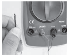
Image 79 : branchez le cordon de mesure noir à la borne d'entrée COM de l'appareil. Le rouge est à raccorder à la borne d'entrée ΩAmA°C.
