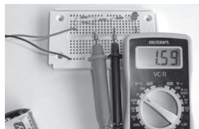
Image 56 : la chute de tension est également la même au niveau de deux résistances de même grandeur, branchées en série.
