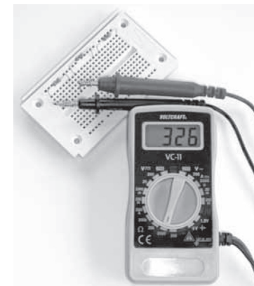
Image 27 : lors d'un réglage de mesure correct, la deuxième résistance mesurée comme une résistance de 1 kΩ à l'origine, est en fait une résistance de 330 Ω.
