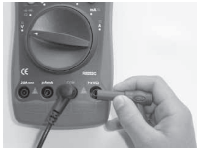
Image 19 : si vous devez effectuer des mesures de tension et de résistance, vous devez, pour ce modèle, brancher le cordon rouge à la borne d'entrée droite HzV \Omega . Si vous souhaitez mesurer de plus faibles intensités, branchez le cordon à la borne \mu AMA.
