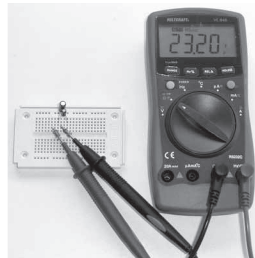
Image 41 : lors de la mesure de deux condensateurs 10 \mu F branchés en série, vous obtenez la somme de chaque capacité des deux condensateurs.
