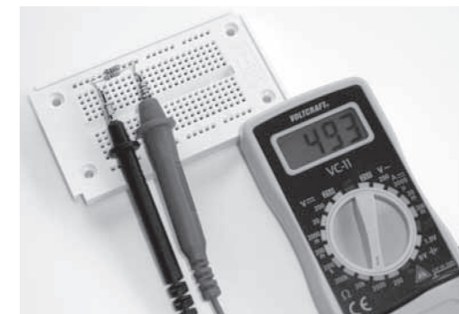
Image 33 : deux résistances de 1Ω montées en parallèle donnent une résistance totale de 493 Ω. Le fait de ne pas obtenir 500 Ω exactement tient du fait des tolérances de fabrication des résistances par le constructeur.
