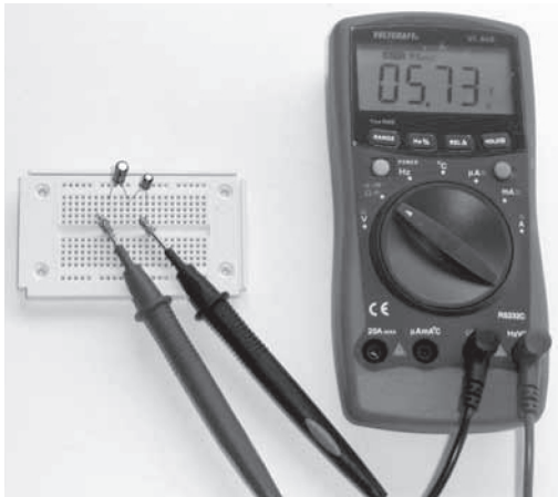
Image 38 : lors de la mesure de deux condensateurs 10 \mu\text{F} montés en série, vous obtenez la moitié de la capacité d'un condensateur.
