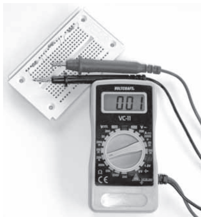
Image 25 : dans la plage de mesure la plus élevée, les résultats de mesure sont assez imprécis.
