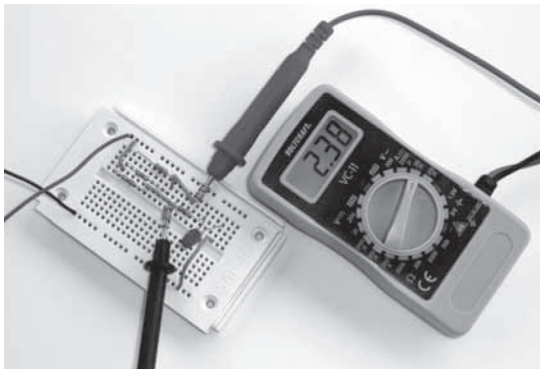
Image 65 : 2,4 mA passent à travers les deux résistances de 330 Ω.
