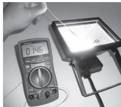
Image 80 : la température de l'air est déterminée à proximité d'un projecteur halogène. Seule la pointe de mesure du fil du capteur de température peut être exposée à des températures élevées.
