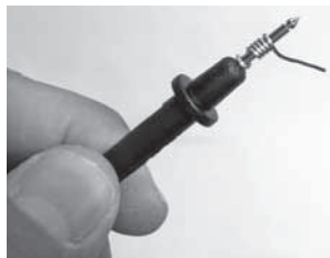
Image 23 : des morceaux de fil de fer d'environ 7 cm sont enroulés autour des pointes de mesure.
