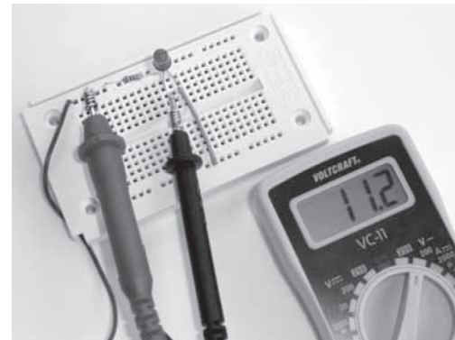
Image 46 : lorsque vous tentez de mesures des chutes de tension sur un circuit avec une plage de tension alternative, on détermine une double tension comme pour le réglage correct de l'instrument sur une tension continue. En effet, rien n'a changé au niveau du circuit par rapport à avant.
