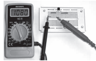
Image 73 : Vous pouvez obtenir une information globale sur le fonctionnement d'un transistor avec un multimètre simple. Pour tester un transistor NPN, positionnez le cordon de mesure rouge sur la connexion de base et positionnez le cordon noir tour à tour sur le collecteur et l'émetteur.
