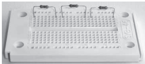
Image 22 : Une fois que vous avez plié les pattes de connexions des trois résistances à 90°, enfichez-les sur la platine d'expérimentation.
