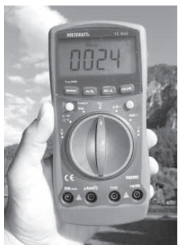
Image 77 : dès que vous avez réglé la plage de mesure température, vous pouvez mesurer la température ambiante.
