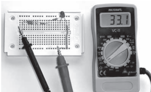
Image 60 : détermination de la résistance total d'un circuit. Si une résistance infiniment grande est mesurée, cela peut indiquer un circuit défectueux.
