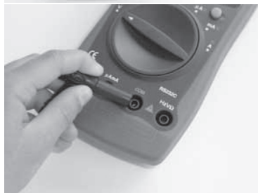
Image 18 : le cordon de mesure noir est à brancher sur la borne COM. Il correspond au retour (pôle négatif).
