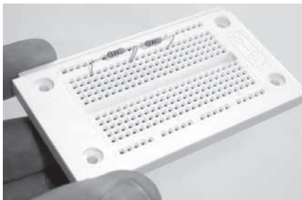
Image 29 : montage en série de deux résistances.
