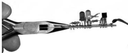
**Figure 62 :** Les pattes raccourcies doivent dépasser de 0,5-1 de la platine.
