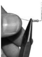
**Figure 30 :** Pour les composants électriques, il ne faut pas plier les fils à l'extrémité immédiate de la bobine.
