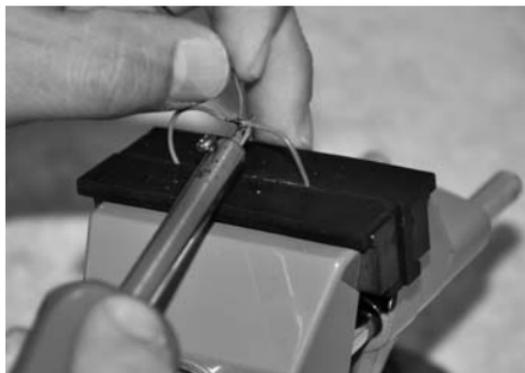
Figure 28 : L'isolation fondant rapidement, la soudure des fils doit être rapide.
