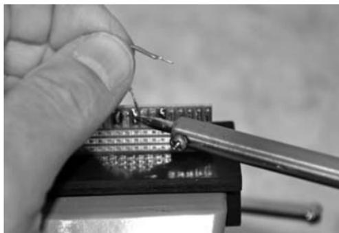
**Figure 35 :** Tout en chauffant une brasure, on tire légèrement sur le fil avec les doigts jusqu'à ce qu'il se détache.
