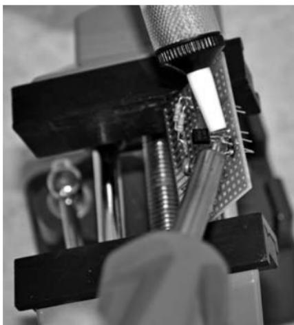
**Figure 57** : Les amas d'alliage s'enlèvent en les chauffant et en les aspirant avec la pompe à dessouder.
