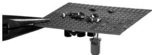
**Figure 63 :** Les fils de raccordement doivent être sectionnés juste au-dessus des points de brasage.
