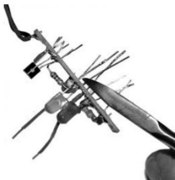
**Figure 61 :** Les surlongueurs des fils doivent être ôtées à la pince plate une fois que le circuit a été achevé et contrôlé.
