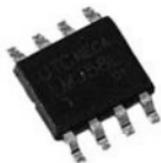
Figure 16 : Sur le CMS-IC, la broche 1 est marquée par un point sur la partie supérieure du boîtier.
