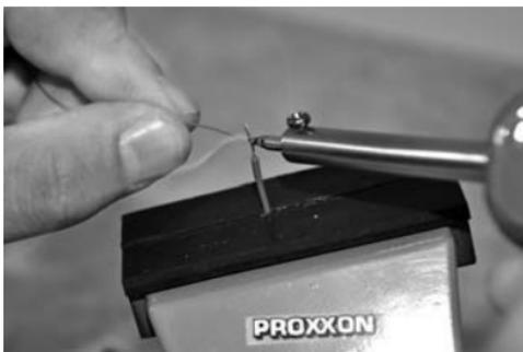
Figure 27 : On chauffe le fil torsadé et on y applique un peu d'alliage, lequel fond instantanément.
