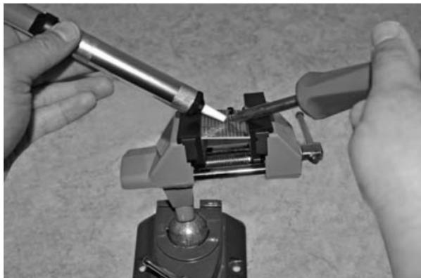
**Figure 65 :** Le dessoudage ne fonctionne qu'à l'aide de la pompe à dessouder.
