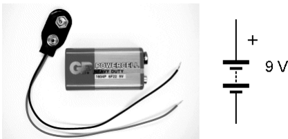
Fig. 3 : Pile réelle et son symbole de commutation. ((B_Batterie.gif))
