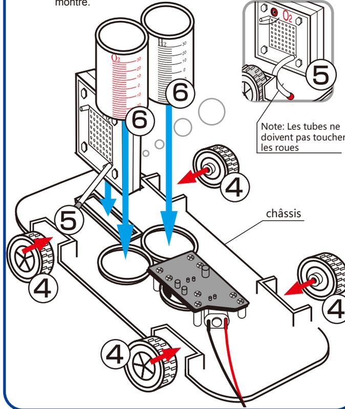
7. Enlever le bouchon rouge du tube court de la pile à combustible côté O<sub>2</sub> et, à l'aide de la seringue, injecter de l'eau distillée à l'intérieur de la pile à combustible jusqu'à la moitié de la hauteur. Replacer le 2 bouchon rouge. ATTENTION : la membrane polymère est une partie essentielle de la pile à combustible. Elle ne doit jamais devenir sèche.
