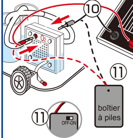
**11.** ALTERNATIVE: brancher le câble rouge du boîtier à piles dans la prise rouge de la pile à combustible. Brancher le câble noir du boîtier à piles dans la prise noire de la pile à combustible. Placer le commutateur du boîtier de batteries en position marche « ON ».
