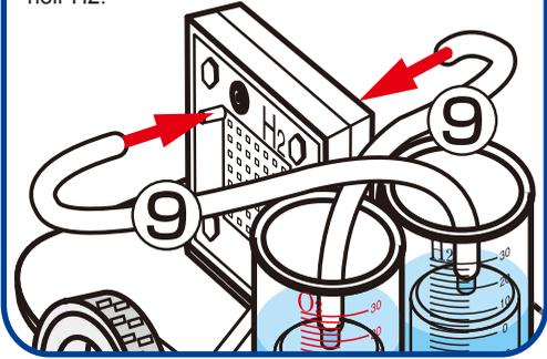
**13.** Utilisation du panneau solaire : débrancher les câbles reliant le panneau solaire à la pile à combustible.
