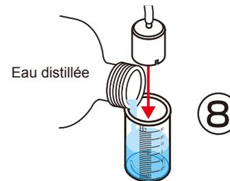
**Note :** pour les remplissages ultérieurs, alors que les cloches internes sont déjà en place dans les cylindres et munies des longs tubes à leur sommet, extraire les deux petits bouchons rouge et noir des tuyaux courts sur la pile à combustible afin que l'eau puisse monter à l'intérieur des cloches. Dès que les cloches sont pleines d'eau, rebrancher les tubes sur les embouts respectifs de la pile à combustible.
