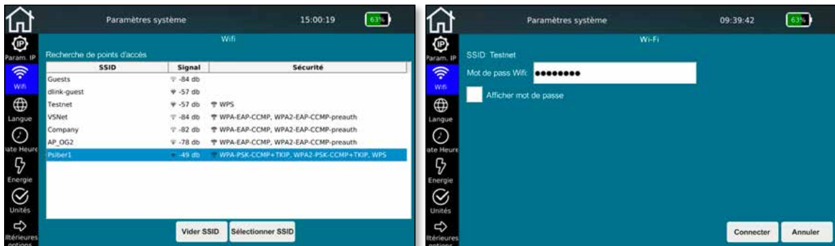
Figure 7 – Sélection du réseau et de la connexion WiFi (avec saisie du mot de passe)
