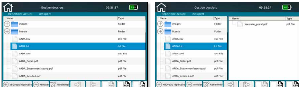
Figure 40 – Dossiers (à gauche, mémoire interne uniquement; à droite, mémoire interne et externe avec clé USB connectée)
