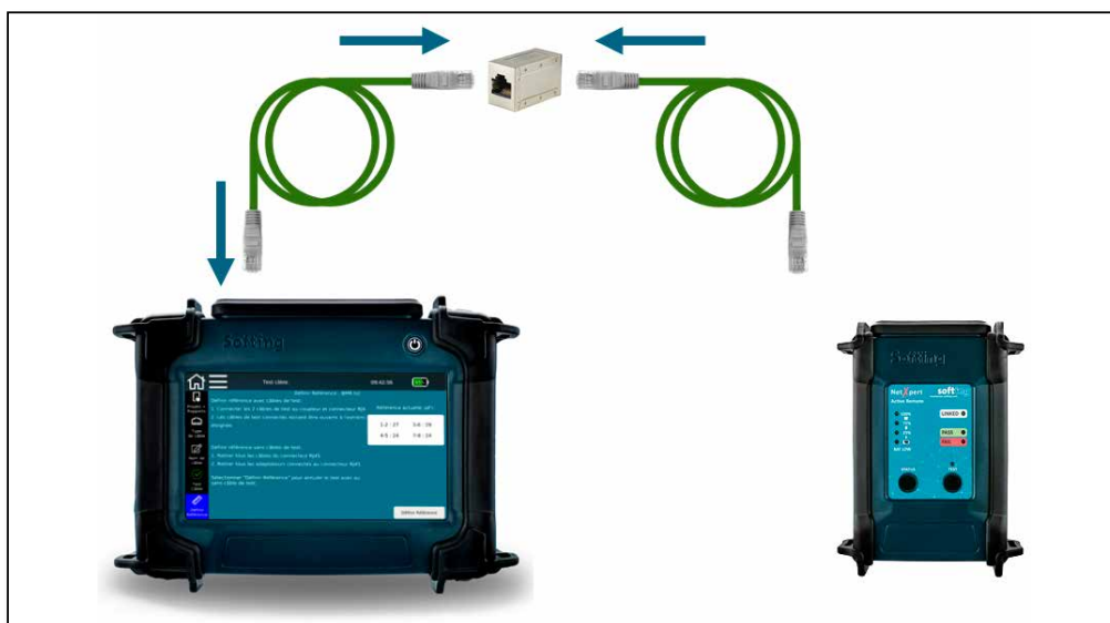
Figure 25 – Configuration du test pour le réglage de la référence
