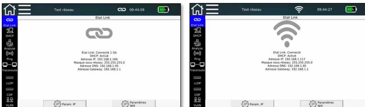
Figure 27 – Statut de link, par connexion câblée (à gauche) ou via WiFi (à droite)
