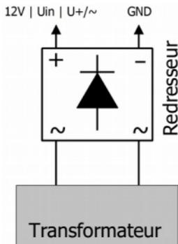
Si vous utilisez le module de clignotant dans un véhicule alimenté en CC analogique, les DEL ne s'allument que dans un sens de marche. Si elles doivent être allumées dans les deux sens de marche, vous devez connecter un pont redresseur (p.ex. article no. 83-19100-10, non inclus) conformément à la figure.
