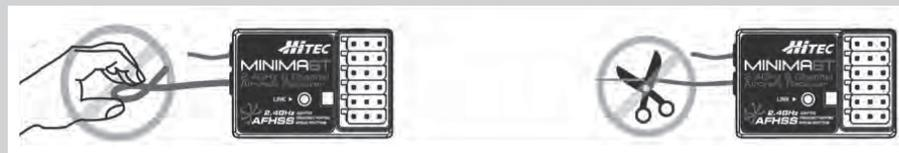
Ne pliez jamais l'antenne, ceci pourrait l'endommager! Le fait de modifier la longueur de l'antenne peut également réduire la portée.
