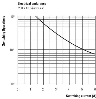
Durée de vie électrique 230 V AC resistive load
