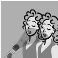
Maximum 2 personnes peuvent chanter dans un micro. L'angle d'incidence ne doit pas être supérieur à 35° !
