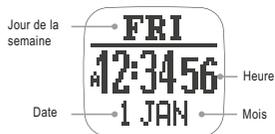
Grâce aux données contenues dans le signal GPS, la montre cardio est capable de synchroniser automatiquement l'heure et la date. La synchronisation s'effectue à chaque fois que la montre cardio calcule une position GPS valable.
