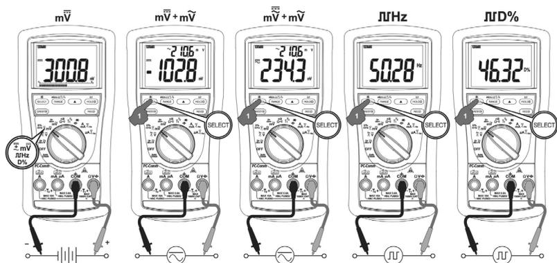
**Fonctions ACmV+Hz (uniquement pour MD 9050), dBm+Hz, Hz+ACmV**
