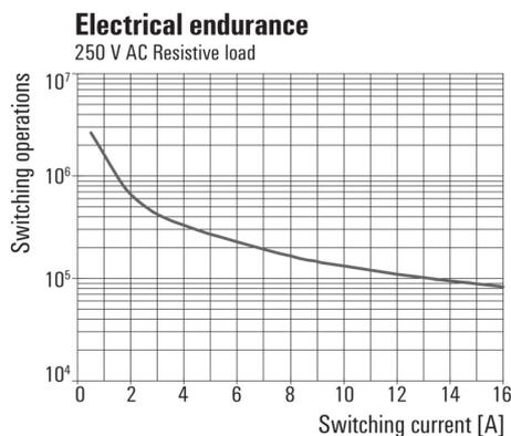
Durée de vie électrique 250 V AC resistive load
