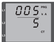
Fig. Mode de programmation du convertisseur d'intensité
