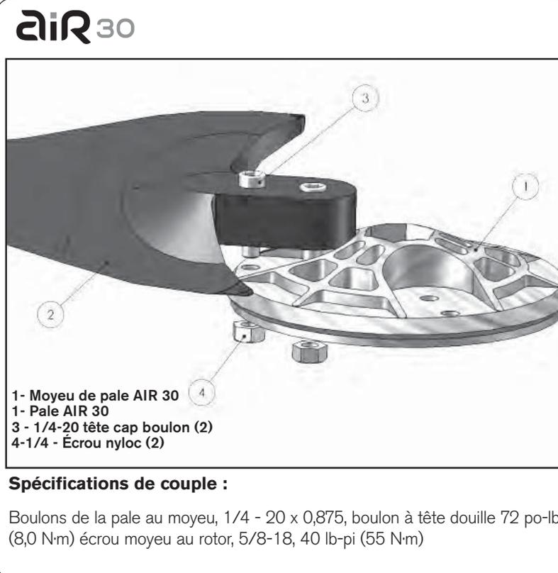
Fig. 2 Détail de la fixation de la pale d'une éolienne AIR 30.
