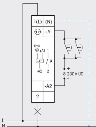
**ou bien** tension de commande 230V avec un courant des lampes néon jusque 5 mA
