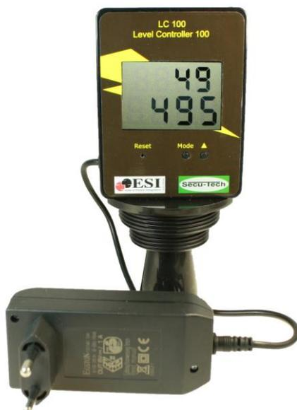
Le LC 101 est un instrument électronique d'affichage de niveau d'un réservoir en pour cent de volume et en litres. Toutes les formes de tanks habituelles sont supportées. La mesure s'est faite en principe ultrasonore de 40 kHz. Le montage est très simple. Le LC 101 est un appareil sans maintenance et très fiable. Le LC 101 est livré avec un adaptateur de réseau 230 V C.A. Le LC 101 est le remplacement idéal des jaugeurs de niveau mécaniques.
