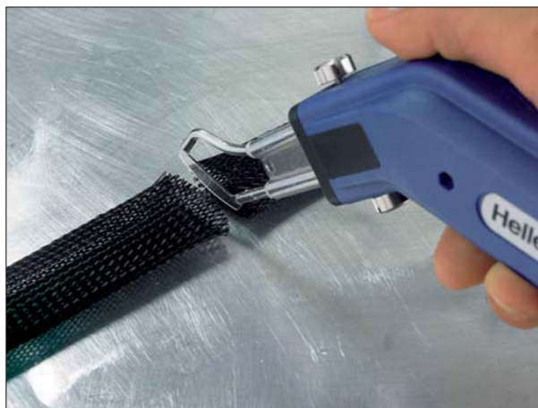
L'outil de coupe HSG0 évite l'effilochage des gaines tressées.
