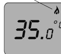
3. Terminez le test en appuyant sur la touche ▼ et abaissez la température souhaitée sur le réglage correct. Le système de chauffage doit s'éteindre et le symbole «chauffage» doit disparaître sur le thermostat.
