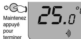
Testez la force du signal, afin de trouver un endroit adapté pour le thermostat, avant que vous ne l'installiez.
