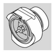
Placer la tête de vanne sur la vanne ou l'adaptateur. Ce faisant, la surface plane doit être orientée vers le haut.
