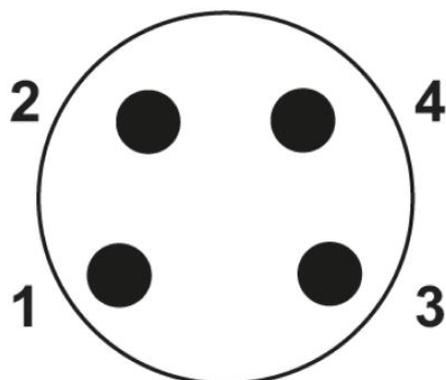
Schéma des pôles, connecteur mâle M8,
