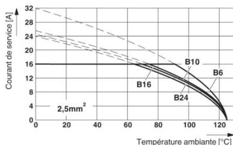
L'illustration représente la courbe de derating de différents isolants pour contacts de série B (B6 à B24), section du conducteur 2,5 mm<sup>2</sup>
