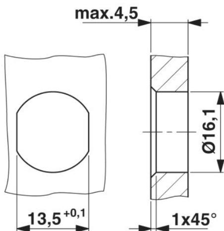
Découpe du boîtier pour filet de fixation M16, paroi de montage avec perçage traversant (alternativement avec surface de protection anti-torsion)
