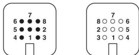
Schéma pôles côté raccord. : connecteur mâle G, femelle D
