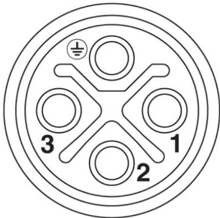
Schéma des pôles du connecteur femelle M12, 4 pôles, détrompage S, vue côté femelle
