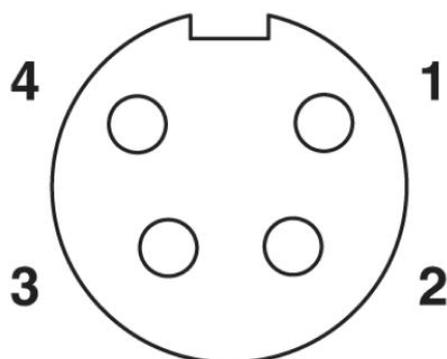
Schéma des pôles connecteur femelle 7/8"-16UNF, 4 pôles, vue côté femelle
