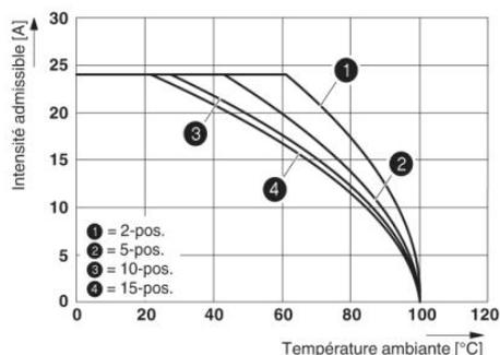
L'illustration montre une courbe de derating de la borne UT 2,5/1P... en liaison avec le connecteur UPBV 2,5
