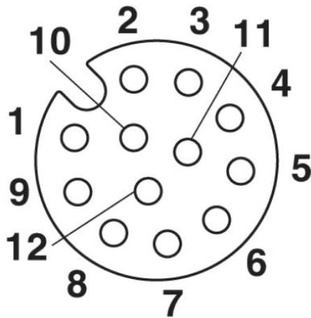
Schéma des pôles connecteur femelle M12, 12 pôles, détrompage A, vue côté femelle
