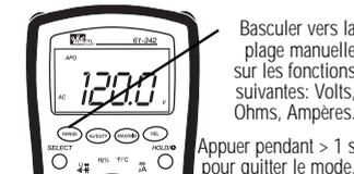
Basculer vers la plage manuelle sur les fonctions suivantes: Volts, Ohms, Ampères.
