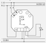
Power MOSFET pour lampes LED 12-36 V DC jusque 4 A, Puls Width Modulation PWM (modulation largeur d'impulsion). Perte en attente de seulement 0,1 Watt. Valeur de luminosité minimale réglable et vitesse de variation réglable. Avec enclenchement chambre d'enfant et de somnolence.
