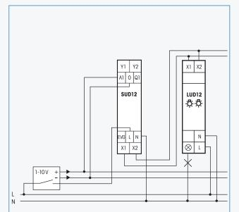
En utilisant cette connexion, et en combinaison d'un module de puissance LUD12 raccordé aux bornes X1-X2, il est possible de transformer la sortie d'un appareil de commande 1-10 V aux bornes A1/0 vers une fonction de variation directe. La commutation de la charge est effectuée également à l'extérieur à la borne L du SUD12.
