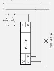
Caractéristiques techniques page B18. Boîtier pour les manuels GBA12 page Z2. Télévariateur universel. Power MOSFET jusque 300 W. Reconnaissance automatique des types de lampes. Pertes en attente de 0,1 Watt seulement. Valeur de luminosité minimale et la vitesse de variation. Avec enclenchement chambre d'enfant et de somnolence.
