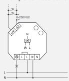
Télévariateur universel. Power MOSFET jusqu'à 400 W. Reconnaissance automatique des types de lampes. Pertes en attente de 0,1 Watt seulement. Valeur de luminosité minimale réglable. Avec enclenchement chambre d'enfant et de somnolence.
