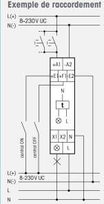
Power MOSFET avec un nombre quasi illimité de commutations jusque 400 W. Reconnaissance automatique des types de lampes. Pertes en attente de seulement 0,3 Watt. Luminosité minimale, luminosité maximale ainsi que soft ON / soft OFF réglable.
