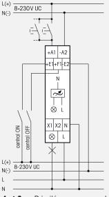
Télévariateur universel. Power MOSFET jusqu'à 400 W. Reconnaissance automatique des types de lampes. Pertes en attente de 0,1 Watt seulement. Valeur de luminosité minimale et la vitesse de variation. Avec enclenchement chambre d'enfant et de somnolence.
