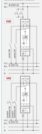
Télévariateur universel. Power MOSFET jusqu'à 400 W. Reconnaissance automatique des types de lampes. Pertes en attente de 0,1 Watt seulement. Valeur de luminosité minimale et maximale réglable ainsi que la vitesse de variation. Avec enclenchement chambre d'enfant et de somnolence.
