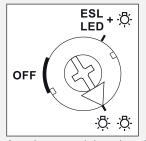
Avec le commutateur dans la position « circuits supplémentaires » (3-3) le LUD12 peut aussi fonctionner comme variateur universel et autonome.
