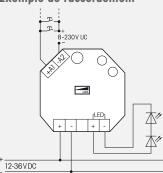
Source de courant DC constant pour lampes à LED jusqu'à 1000 mA respectivement 30 Watt. Perte en attente de seulement 0,1 Watt. Valeur de luminosité minimale réglable et vitesse de variation réglable. Avec enclenchement chambre d'enfant et de somnolence.
