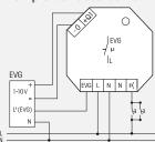
1 contact NO, non libre de potentiel,  $600\,\text{VA}$  en une sortie de commande 1-10 V de 40 mA. Perte en attente de seulement 1 Watt.
