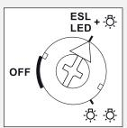
Le commutateur, sur la face avant, doit se trouver dans cette position pour ESL et LED de 230 V, lorsque le télévariateur est utilisé dans les positions de confort ESL ou LED. Aussi bien pour augmentation de puissance avec des circuits supplémentaires.
