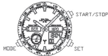
L'écran LCD indique désormais MPO (Minute Position) et les minutes numériques clignotent. Appuyez sur Start/Stop pour les ajuster aux minutes analogiques. Terminez ensuite le calibrage en appuyant brièvement sur SET, de sorte que RX apparaisse dans l'affichage supérieur droit du LCD. La réception commence alors et les aiguilles commencent à tourner (appel émetteur). Lorsque la réception est effectuée, le symbole antenne apparaît dans le champ supérieur gauche du LCD.
