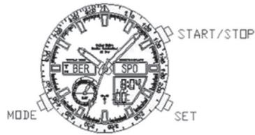
L'affichage LCD change ensuite sur HPO (Hour Position) et l'heure numérique clignote. Appuyez sur Start/Stop pour régler l'heure numérique sur l'heure analogique. Appuyez alors sur Mode pour valider et pour accéder au réglage suivant.
