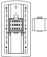
La station météo utilise 3 piles 1,5V de type AA, IEC LR6. Pour installer et remplacer les piles, veuillez procéder de la façon suivante :
