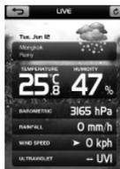
**REMARQUE** Les données de température et humidité sur la page **LIVE** viennent de votre capteur de température et humidité sur le canal 1.
