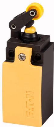
**Interrupteur de position, Levier à galet, Appareil complet, 1 F, 1 O, Borne à vis, jaune, Matière isolante, -25 - +70 °C, EN 50047 Forme E, longue**
