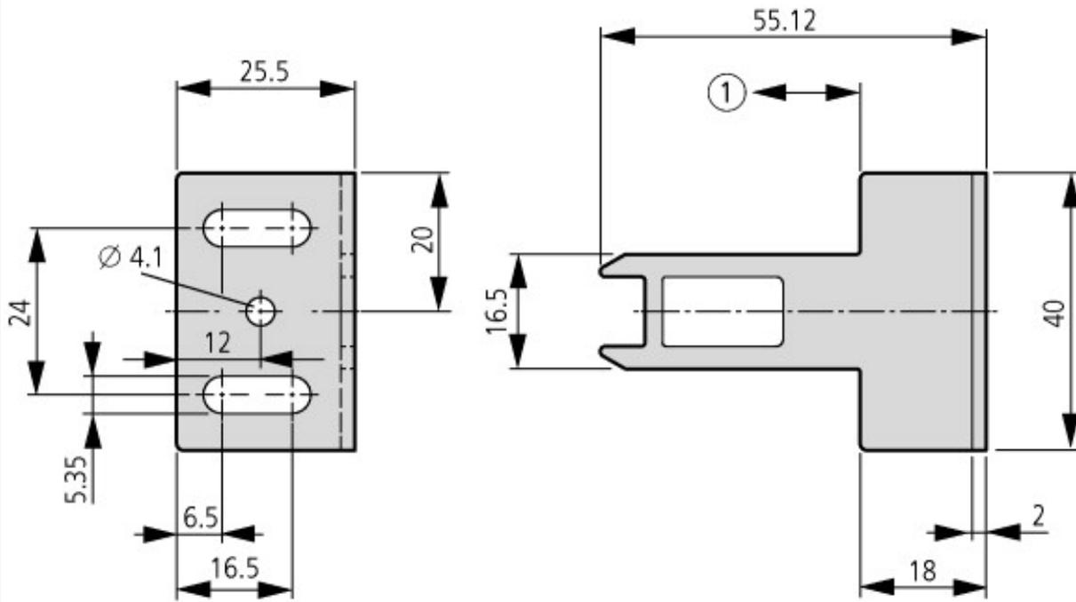
Terminer le montage en insérant une goupille de 4-mm.
