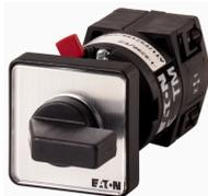
**Inverseurs, Contacts: 2, 10 A, plastron: 1-0-2, 60 °, à accrochage, Montage encastré avec fixation centrale**
