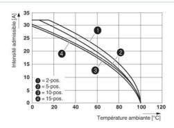
L'illustration montre une courbe de derating de la borne ST 4... en liaison avec le connecteur SP 4
