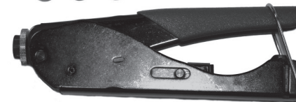
KPZ 4 Pince à compression, réglable, pour tous les connecteurs à compression F 51..., 49..., 37, 32, RCA, BNC et ICE (pas de prise à câble enterré), changement d'outil grâce à une technique d'aimants
