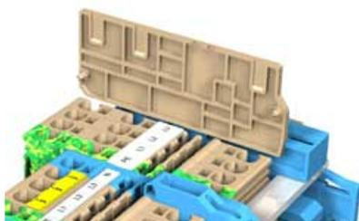
Les plaques de maintien qui servent également de plaques de fermeture dans la série P doivent être disposées tous les 200 mm lors de l'utilisation de barres collectrices 10 x 3
