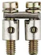
Les entretoises DS en matériau isolant sont utilisées pour pouvoir couper les circuits quand on enlève les vis de fixation. Le courant de la connexion transversale passe dans ce cas par la vis de fixation. C'est pourquoi nous prescrivons d'utiliser des vis en CuNi 60 (alliage cuivre-nickel). Pour ranger les vis de fixation qui ont été enlevées on utilise une équerre de blocage avec support de vis.
