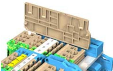
Les plaques de maintien qui servent également de plaques de fermeture dans la série P doivent être disposées tous les 200 mm lors de l'utilisation de barres collectrices 10 x 3
